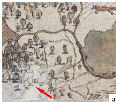
Il. 13. Rekonstrukcje brakującej partii mapy wykonane na podłożu papierowym ręcznie czerpanym na sicie żeberkowym, wykonane odręcznie atramentem metalo-garbnikowym (po lewej: bryt nr 8 po konserwacji-restauracji; po prawej: bryt nr 5 przed zabiegami); wzdłuż dolnej krawędzi brytu nr 5 znajdowały się również uzupełnienia podłoża mapy wykonane z papieru maszynowego (fot. Jolanta Czuczko)
