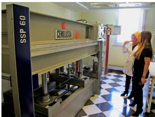
II. 9. Wielka prasa hydrauliczna do prostowania obiektów o znacznych rozmiarach w pracowni konserwacji Archiwum Osmańskiego (Başbakanlık Osmanlı Arşivi) w Stambule (fot. Anna Czajka)
