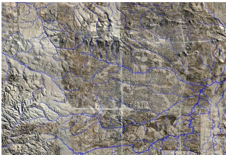
Il. 1. Mapa Hindenberga naniesiona na współczesny Numeryczny Model Terenu oraz warstwę wektorową rzek. W skali 1:300 000 mapa wykazuje zastanawiającą dokładność w części zachodniej i nieco mniejszą w części wschodniej (źródło: opracowanie własne)
